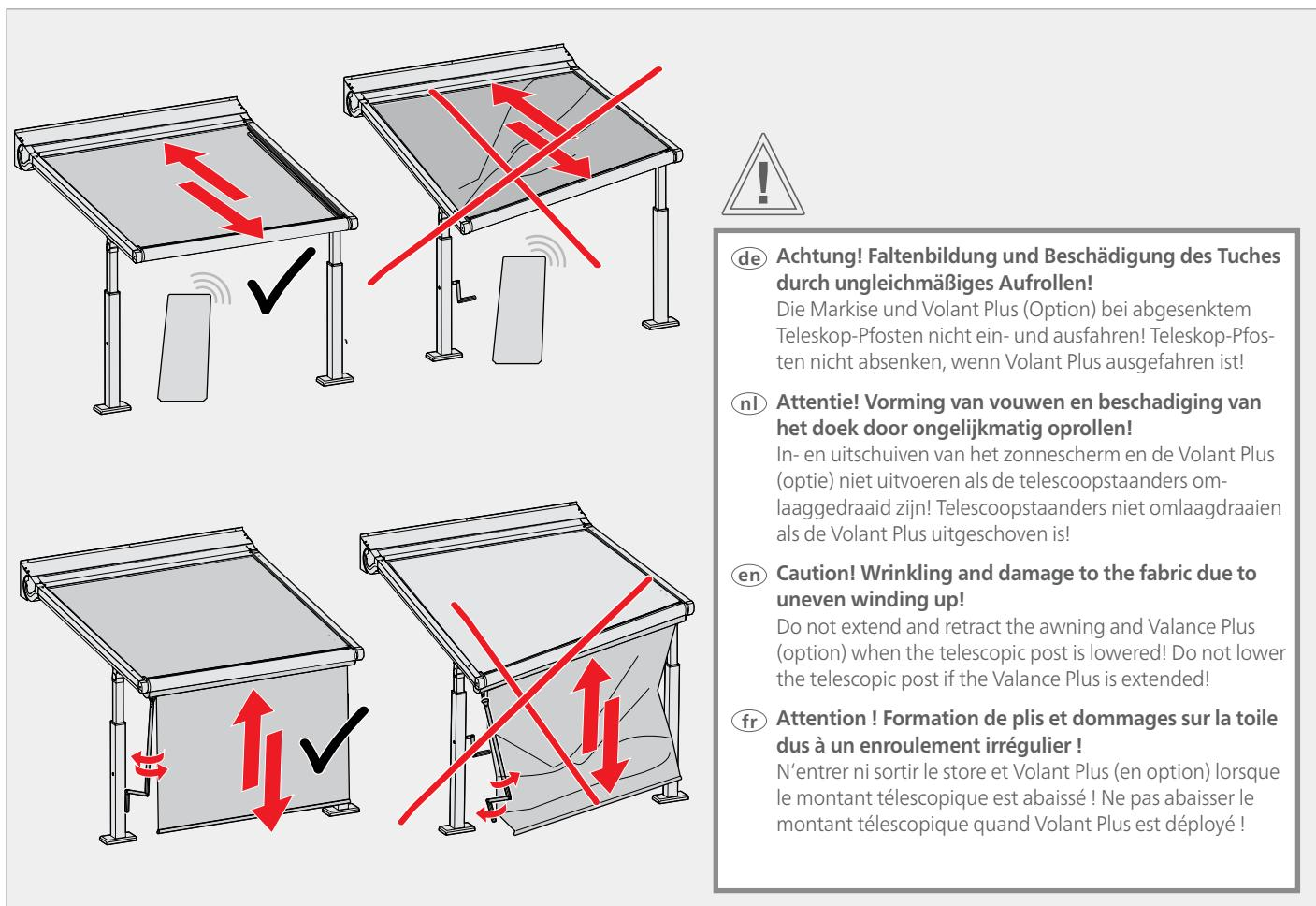
**(de) Achtung! Faltenbildung und Beschädigung des Tuches durch ungleichmäßiges Aufrollen!**
